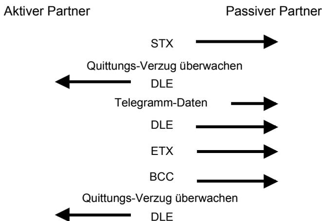
Sie können pro Telegramm maximal 255Byte übertragen.
