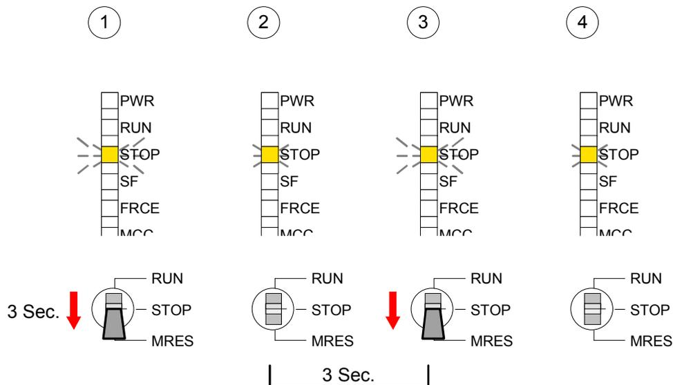
Mit Urlöschen werden die in protect.wld enthaltenen Bausteine, permanent vor Zugriffen Dritter geschützt, in der CPU abgelegt.
