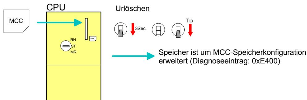
Sollte die Speichererweiterung auf der MCC den maximal erweiterbaren Speicherbereich der CPU überschreiten, wird automatisch der maximal mögliche Speicher der CPU verwendet.
