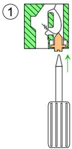
Hier können Sie Drähte mit einem Querschnitt von  $0,08\text{mm}^2$  bis  $2,5\text{mm}^2$  anschließen. Hierbei dürfen sowohl flexible Litzen ohne Aderendhülse, als auch starre Leiter verwendet werden.
