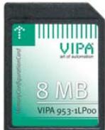
Bei der CPU haben Sie die Möglichkeit den Arbeitsspeicher zu erweitern. Hierzu ist bei VIPA eine MCC-Speichererweiterungskarte verfügbar. Bei der MCC handelt es sich um eine speziell konfigurierte MMC (**M**ultimedia **C**ard). Durch Stecken der MCC im MCC-Slot und anschließendem Urlöschen wird die entsprechende Speichererweiterung freigeschaltet. Es kann immer nur eine Speichererweiterung aktiviert sein.
