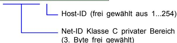
Damit der PC ohne Verwendung einer Routing Tabelle alle CPU 51xS Steckkarten und die dahinterliegenden CPUs ansprechen kann, ist es Voraussetzung, dass jeweils eine **eigene Net-ID** verwendet wird:
