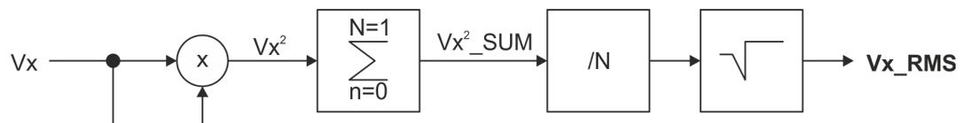
1. Das Quadrat der aktuell gemessenen Spannung  $V_x$  wird berechnet.
