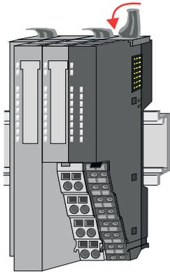
6. ➔ Klappen Sie den Verriegelungshebel des Peripherie-Moduls wieder nach unten.
