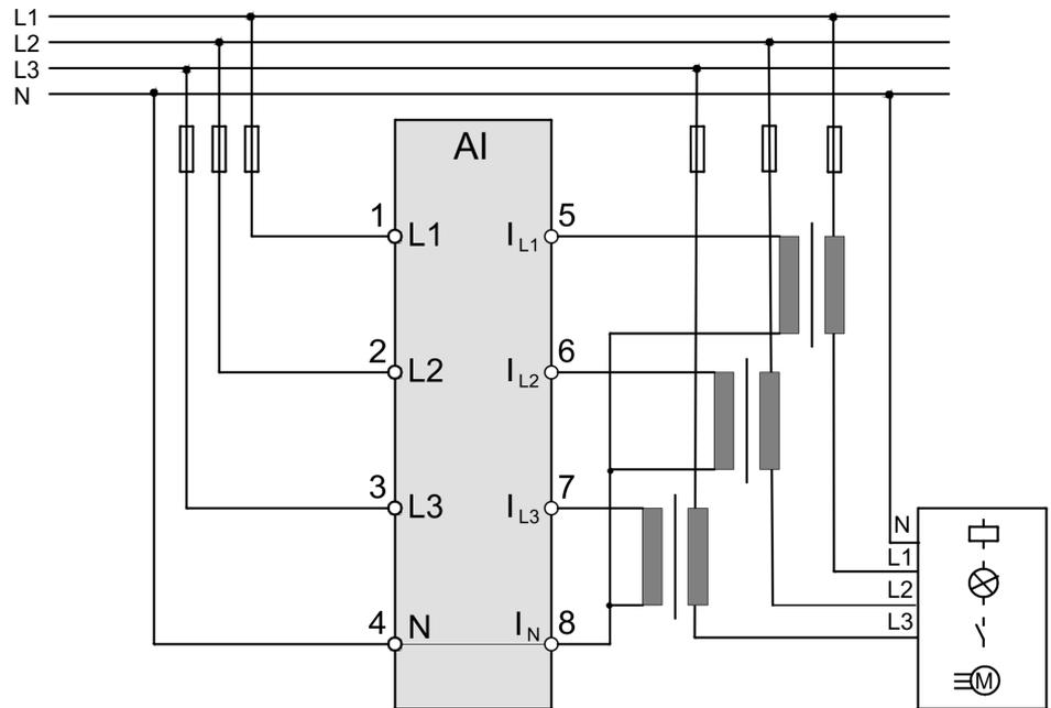
**Anschluss über Strom- / Spannungswandler**
