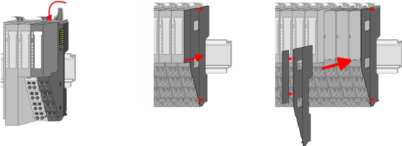
7. ▶ Nachdem Sie Ihr Gesamt-System montiert haben, müssen Sie zum Schutz der Bus-Kontakte die Bus-Blende am äußersten Modul wieder stecken. Handelt es sich bei dem äußersten Modul um ein Klemmen-Modul, so ist zur Adaption der obere Teil der Bus-Blende abzubrechen.
