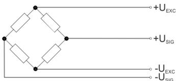
Bei der 4-Leiter-Messung bleiben die  $U_{SEN}$ -Anschlüsse frei. In dieser Betriebsart wird innerhalb des Moduls eine Verbindung zwischen  $U_{EXC}$  und  $U_{SEN}$  hergestellt.
