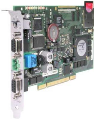
Die CPU 51xS stellt eine vollwertige SPS-CPU in Form einer PCI-Bus-Karte für PC-basierte Anwendungen dar. Unterstützt werden die Windows®-Betriebssysteme 98, ME, NT4, 2000 und XP.
