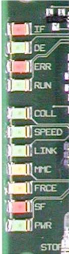
Auf der Steckkarte befindet sich insbesondere für die Inbetriebnahme bzw. den externen Einsatz eine LED-Leiste zur Statusanzeige von CPU, Ethernet und Profibus-DP-Master. Zur Kontrolle der karteninternen Kommunikation befinden sich nahe der Steckleiste 3 LEDs die während der Kommunikation blinken bzw. leuchten.
