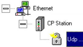
Bei UDP werden die Telegramme ohne Empfangsquittung übertragen. UDP eignet sich zur Übertragung von sich ständig ändernden Informationen. Wenn eine Übermittlung nicht erfolgt ist, erfolgt die nächste, aktuellere bereits einige Sekunden später.
