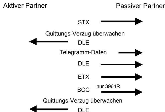
Sie können pro Telegramm maximal 250Byte übertragen.
