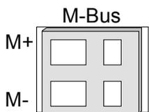
Die Bezeichnung M+ und M- dienen zur Unterscheidung der M-Bus-Leitungen. Die Polung ist bei M-Bus-Installationen völlig unerheblich.
