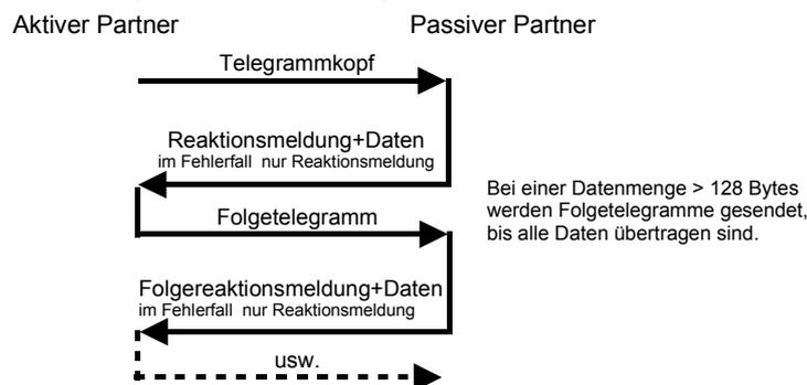
In beiden Fällen wird maximal 5s auf die Reaktionsmeldung gewartet, und danach der Empfang abgebrochen.
