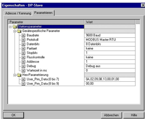
In diesem Teil der Parametrierung stellen Sie die Modbus-Parameter ein.
